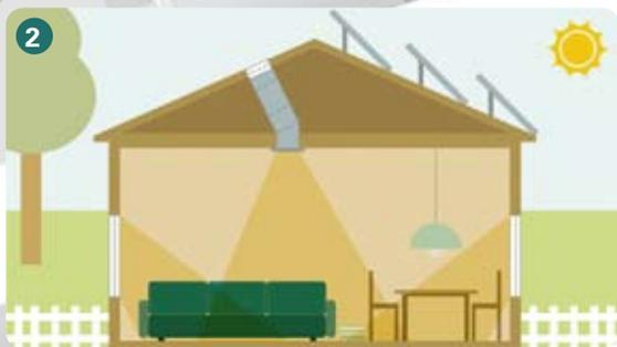
Lámparas más eficientes (LED), iluminación natural con tragaluces, tubos de luz solar y la introducción de inteligencia en las ventanas reducen mucho el consumo de energía para iluminación.
