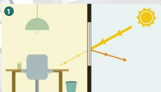
El consumo energético para climatizar los edificios se reduce al mínimo mediante: diseño bioclimático; espesor de aislante óptimo para cada clima en paredes, cubiertas y suelo; ventanas con control solar y térmico activo.
